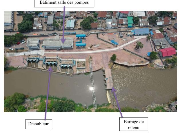
On trouve sur le site de ce captage deux anti-béliers et des équipements électriques nécessaires au fonctionnement de la station de pompage.
